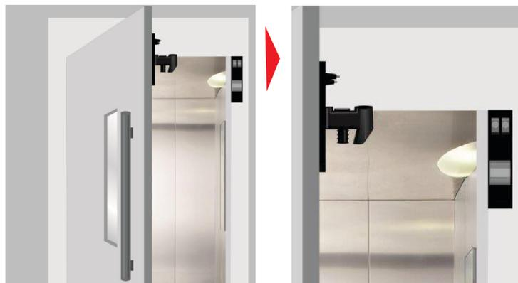
O trinco TV4 é um dispositivo eletromecânico que mantém as portas de pavimento de abertura manual (porta de eixo vertical) fechadas e travadas, impedindo sua abertura enquanto o elevador não estiver parado no andar. O trinco TV4 ainda monitora eletricamente a situação da porta (fechada ou aberta) e envia essa informação para o quadro de comando que libera ou não a movimentação do elevador.
