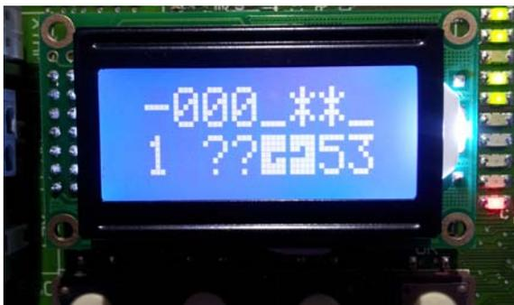
Sistema de interface homem-máquina (IHM), que indica as ocorrências ao técnico, agilizando as manutenções corretivas.
